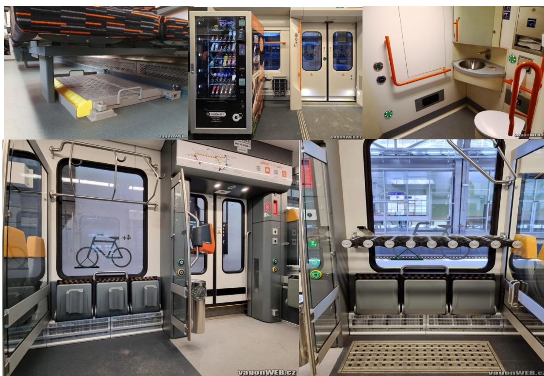
Obr. č. 7 Pohľad na komponenty, ktoré by mal obsahovať nami navrhnutý vozeň ( držiaky na bicykle, sklápacie sedačky, plošina pre nástup invalidných cestujúcich, bezbariérové upravené toalety)
