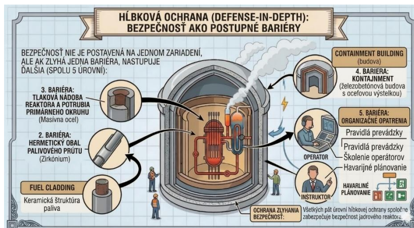
Obr. 6: Systém hĺbkovej ochrany (Defense-in-Depth)
